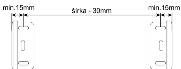
Umiestnenie konzoliek rolety
